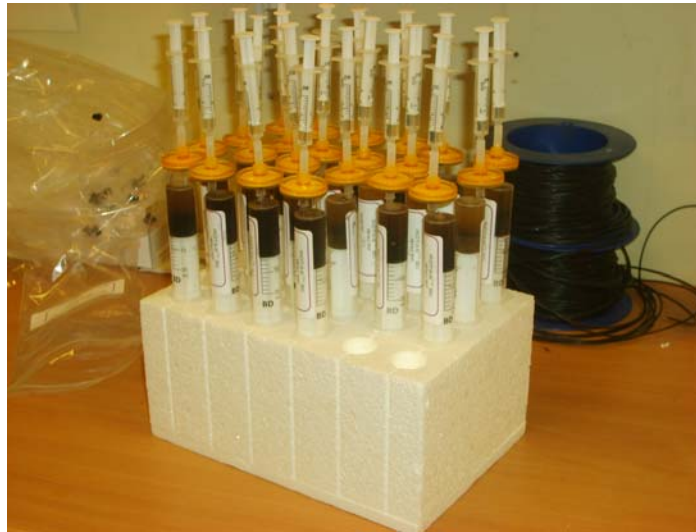
Figur 2. Sprutor innehållande jord som skakats tillsammans med extraktionsmedel. Ett 0,45 mikron-filter med en 2 ml-spruta sattes på varje spruta.
