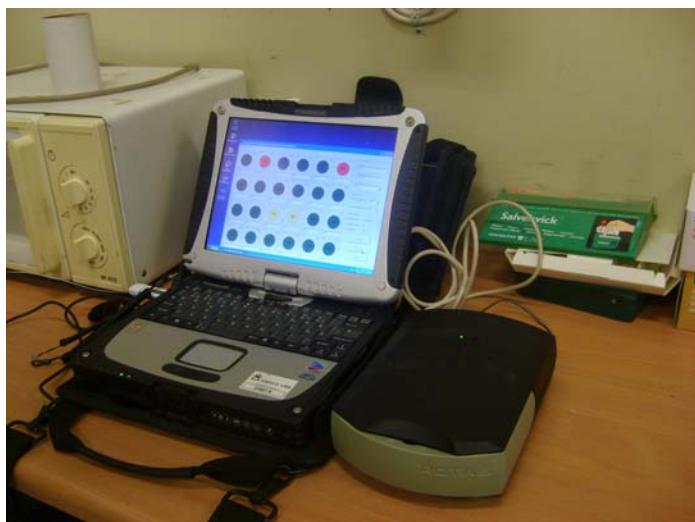
Figur 3. Pågående ROTAS-test. En dator med ROTAS-programvara samt en provplatta ansluten till en luminometer.
